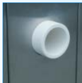
Průzor pro kontrolu vypalu
